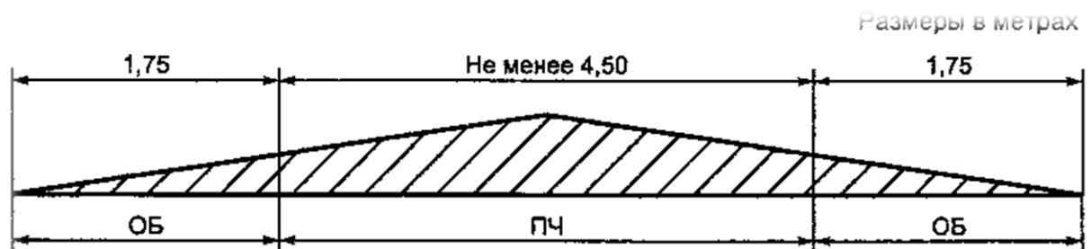
Рис. Поперечный профиль автомобильных дорог категории V ПЧ — проезжая часть, ОБ — обочина.
